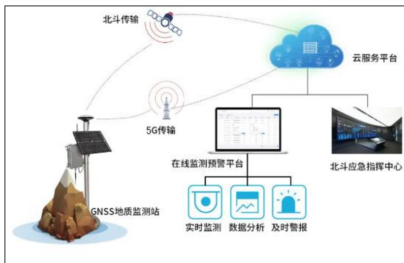
图 5.6-1 GNSS 监测系统工作原理图
