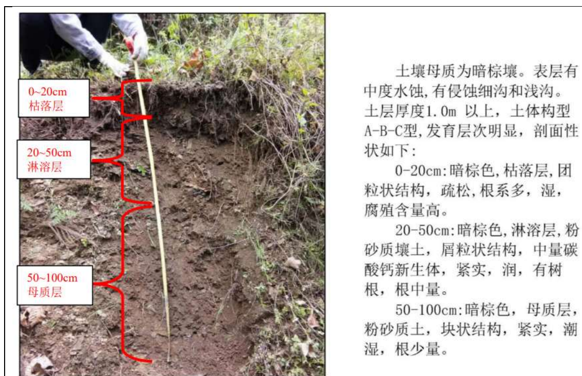
图 2-5 项目区典型土壤剖面图
